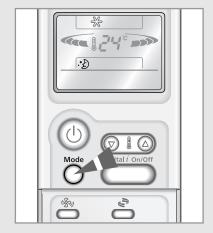
La fonction Sleep Timer permet d'arrêter le climatiseur automatiquement après 6 heures de refroidissement ou de chauffage.
