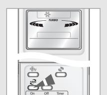
La fonction de refroidissement/chauffage Turbo vous permet d'augmenter ou de baisser la température de la pièce rapidement.
