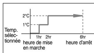
**Chauffage** La température baisse de 1°C par heure. Lorsqu'elle baisse de 2°C (après 2 heures), la nouvelle température est maintenue pendant 4 heures.
