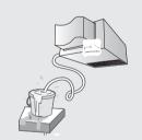
▶ Installez le tuyau d'évacuation pour que l'eau coule sûrement et correctement.
