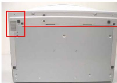
2). Déplacez le verrou de sécurité dans la position "déverrouillé (unlocked)".
