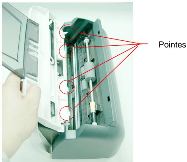
4. Insérez deux pointes dans le milieu du plateau ADF dans les trous sur le dessus du scanner.
