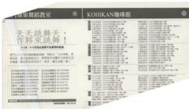
Remarque : Si l'angle de d'inclinaison est trop important, une partie de l'image risque d'être coupée.
