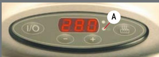
L'affichage du panneau de commande indique la température de veille du compartiment à pierres. Une température minimale de 260 à 280 degrés est nécessaire si vous souhaitez que le poêle soit toujours prêt à l'utilisation. Le témoin lumineux A est allumé lorsque le poêle est en mode veille « LO ». Utilisez les boutons [-] et [+] pour régler la température de veille.
