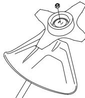
Pose: serrer l'écrou dans le sens contraire de la rotation de l'équipement de coupe. Dépose: desserrer l'écrou dans le sens de la rotation de l'équipement de coupe. (NOTA! L'écrou est fileté à gauche.) Serrer l'écrou à l'aide de la clé à canon.
