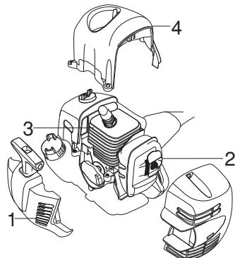
Nettoyer le système de refroidissement avec une brosse une fois par semaine, voire plus souvent dans des conditions difficiles. Un système de refroidissement sale ou colmaté provoque la surchauffe de la machine, endommageant le cylindre et le piston.
