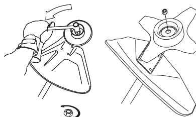
L'usure du verrouillage nylon du contre-écrou ne doit pas être telle qu'il peut se visser à l'aide des doigts. Le verrouillage doit résister à 1,5 Nm au moins. Remplacer le contre-écrou après une dizaine de serrages.
