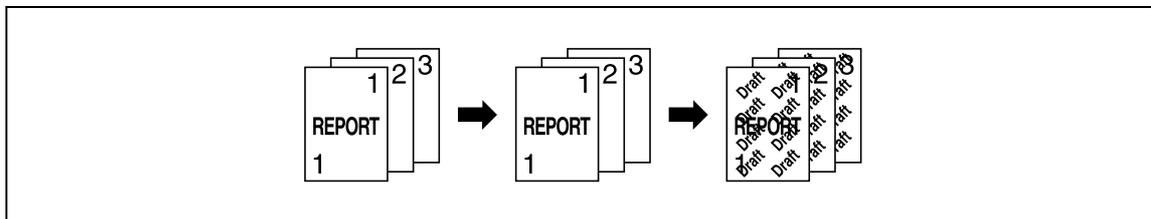
Il est possible de placer jusqu'à huit caractères et tampons. Si le texte et les tampons à insérer sont définis à 45 (-45) degrés, jusqu'à quatre zones sont nécessaires.
