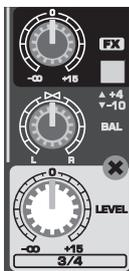
Fig. 2.6: Les potentiomètres départ d'effet/balance/Level
