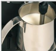
Versez le lait dans votre pot à lait. Ne le remplissez qu'à la moitié. Plongez la buse vapeur dans le lait.
