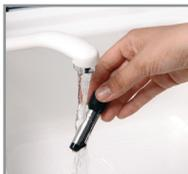
La buse vapeur est démontable pour permettre un nettoyage en profondeur. Lavez-la avec de l'eau et un peu de savon à vaisselle non abrasif au moyen d'une brosse. Rincez-la et séchez-la. Avant de la remettre en place, assurez-vous que les trous d'entrée d'air ne sont pas bouchés par des résidus de lait. Débouchez-les avec l'aiguille fournie si nécessaire.
