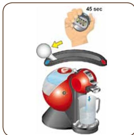
23. Placer le levier de réglage de l'eau sur la position « eau froide ».
