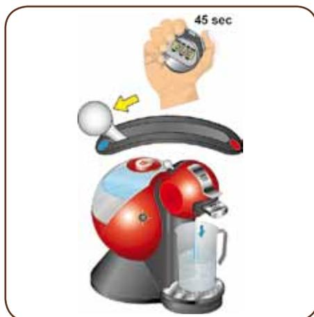
12. Placer le levier de réglage de l'eau sur la position « eau froide ».
