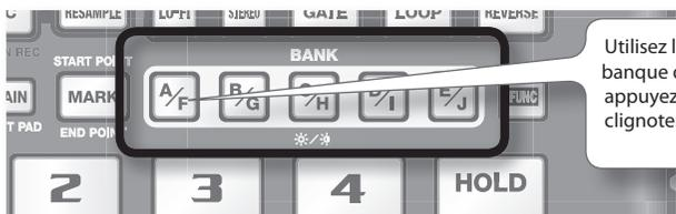
Utilisez les boutons [A/F]–[E/J] pour changer de banque de samples. Pour sélectionner la banque F, appuyez deux fois sur le bouton [A/F] ; il se met à clignoter.
