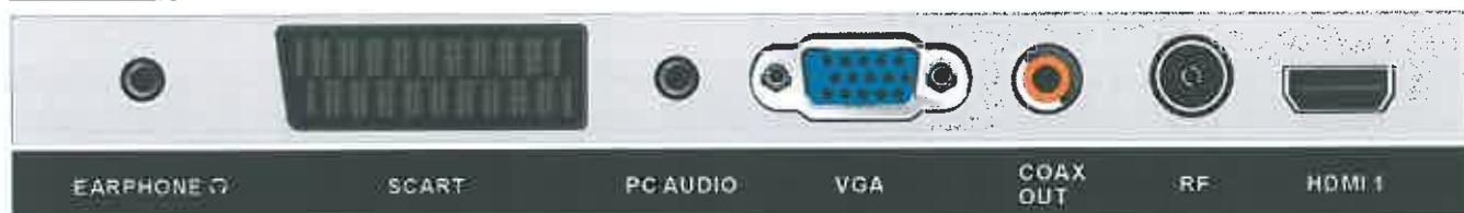
**Utilisez un câble coaxial pour connecter un amplificateur audio ou autre appareil de décodage audio pour sortie audio coaxiale. (Le câble coaxial n'est pas fourni)**
