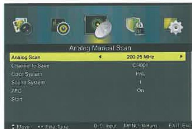
**NOTE:** Le Système couleurs, le système Son et l'AFC ne pourront pas être réglés s'il n'y a pas de signal.
