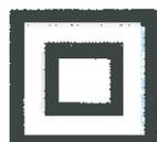
Cet appareil appartient à la catégorie II ou appareil électrique à double isolation. Sa conception n'exige pas de prise terre/masse.
