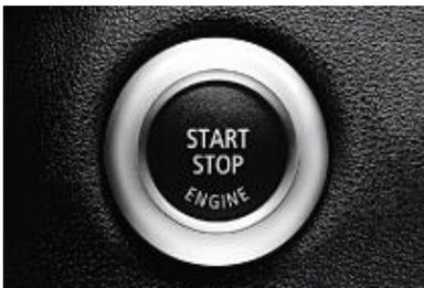
■ **Bouton de démarrage « Start/Stop ».** Lorsque la clé à télécommande est insérée, il suffit d'appuyer sur le bouton pour démarrer ou arrêter le moteur.
