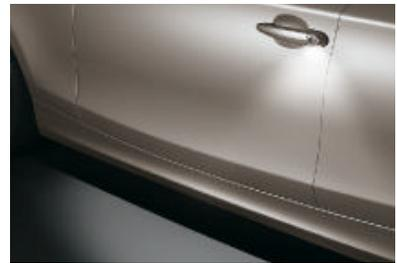
□ **Kit éclairage.** Il comprend des poignées de portes extérieures avec éclairage intégré qui illuminent la zone d'accès au véhicule pendant 20 secondes après le déverrouillage des portes. Autres équipements compris : liseuses à l'avant, éclairage du bas de l'habitacle à l'avant, miroirs de courtoisie éclairés côté conducteur et passager avant et éclairage d'ambiance.
