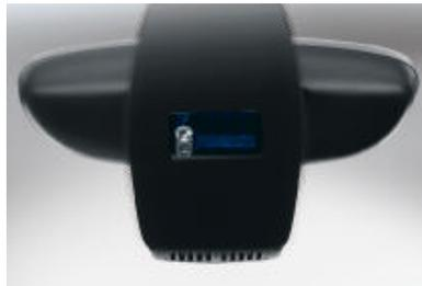
■ **Détecteur de pluie et allumage automatique des projecteurs.** Une fois activé, il enclenche automatiquement les essuie-glace et commande la cadence du balayage en fonction de l'intensité de la pluie. La fonction intégrée d'allumage automatique des projecteurs actionne les feux de croisement au crépuscule ou au passage dans un tunnel.
