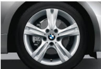
□ **Jantes en alliage léger 17" style 262 à rayons en étoile** avec monte pneumatique mixte RSC permettant le roulage à plat. Dimensions : 7 J x 17 pouces à l'avant, pneumatiques 205/50 R 17 ; 7,5 J x 17 pouces à l'arrière, pneumatiques 225/45 R 17. Non disponibles sur BMW 135i.
