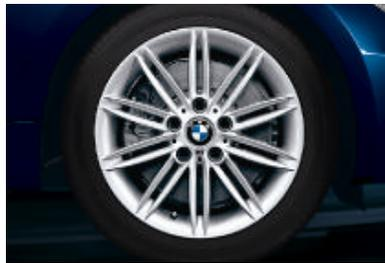
**Jantes en alliage léger 17" style 207 M à rayons doubles** avec monte pneumatique mixte RSC permettant le roulage à plat. Dimensions : 7 J x 17 pouces à l'avant, pneumatiques 205/50 R 17 ; 7,5 J x 17 pouces à l'arrière, pneumatiques 225/45 R 17. Non disponibles sur BMW 135i Sport Design.
