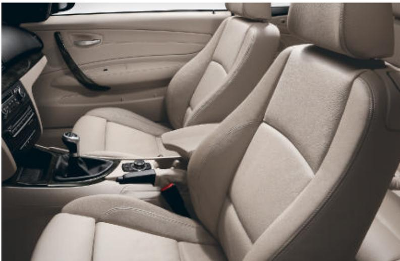
□ **Sièges avant Sport** (revêtus du cuir Boston « Beige » optionnel sur la photo) assurant un maintien latéral optimal grâce au réglage électrique en continu de la largeur des dossiers. Avec réglage manuel de la position longitudinale du siège et de la hauteur de l'assise, de l'inclinaison du dossier et de l'assise, et réglage de la longueur de l'assise. De série sur BMW 135i.
