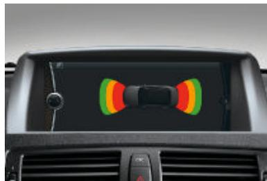
□ **Système d'aide au stationnement PDC**, disponible pour l'avant et l'arrière ou uniquement pour l'arrière. Il facilite les manœuvres sur les emplacements les plus étroits. La distance entre votre BMW et un obstacle est indiquée par un signal sonore (et visuel en combinaison avec un système de navigation optionnel).
