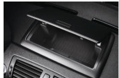
□ **Kit rangement :** il comprend deux porte-bouteilles (un seul en combinaison avec un système de navigation), des filets sur les dossiers des sièges avant, une prise 12 V et un filet de rangement sur la droite dans le coffre, deux sangles de maintien sur le fond du coffre ainsi qu'un compartiment de rangement dans la partie supérieure de la planche de bord (non disponible en combinaison avec un système de navigation).
