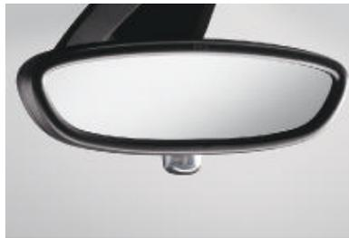
□ **Rétroviseur intérieur électrochrome.** Selon l'intensité des faisceaux provenant des véhicules qui se trouvent derrière vous, le rétroviseur intérieur, de grande taille, s'assombrit automatiquement.
