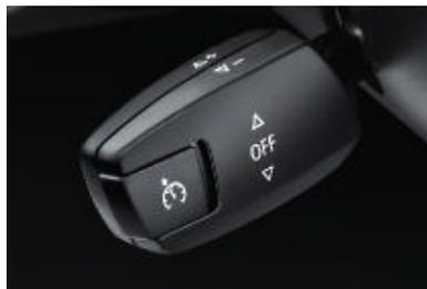
■ **Régulateur de vitesse.** À partir de 30 km/h environ, il mémorise la vitesse souhaitée (commande par le levier placé sur la colonne de direction, à gauche) et la maintient constante. La fonction se désactive lorsque le conducteur freine. Lorsqu'il actionne à nouveau le régulateur, le véhicule accélère jusqu'à atteindre la vitesse précédemment mémorisée.
