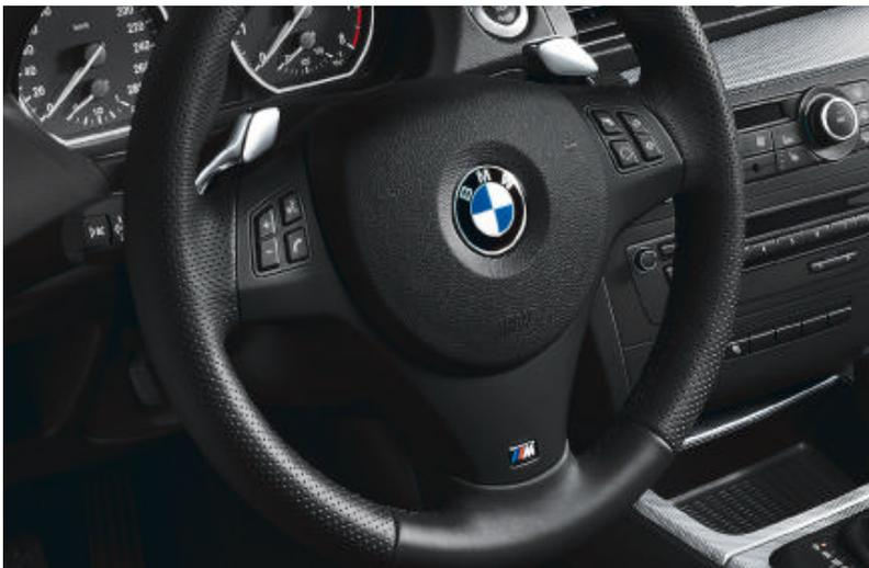
□ **Palettes de changement de rapports au volant** (en combinaison avec la boîte de vitesses automatique à 6 rapports avec Steptronic) permettant de changer de rapport manuellement sans débrayer. Disponible uniquement sur BMW 125i, 135i et 123d.
