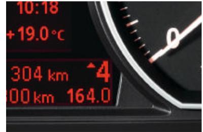
■ **Indicateur de changement de rapport** pour les modèles avec boîte de vitesses manuelle à 6 rapports. Il favorise une conduite économique en indiquant le moment idéal pour passer le rapport supérieur ou rétrograder en fonction du style de conduite. Il vous conseille notamment de changer de vitesse à l'accélération si un autre rapport permet d'accélérer suffisamment vite en consommant moins.
