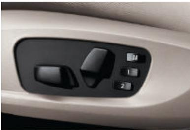
□ **Sièges avant électriques** (hauteur d'assise, position longitudinale, et inclinaison de l'assise et du dossier), avec mémoires conducteur et rétroviseurs extérieurs (avec basculement automatique du rétroviseur extérieur droit au passage de la marche arrière). Possibilité d'enregistrer deux positions du siège conducteur et des rétroviseurs extérieurs.
