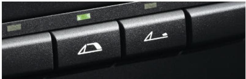
■ **Touches de commande de capote** pour ouvrir ou fermer la capote de manière entièrement automatique. L'ouverture peut être déclenchée en roulant jusqu'à 40 km/h.
