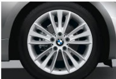
□ **Jantes en alliage léger 18" style 263 à rayons en W** avec monte pneumatique mixte RSC permettant le roulage à plat. Dimensions : 7,5 J x 18 pouces à l'avant, pneumatiques 215/40 R 18 ; 8,5 J x 18 pouces à l'arrière, pneumatiques 245/35 R 18.
