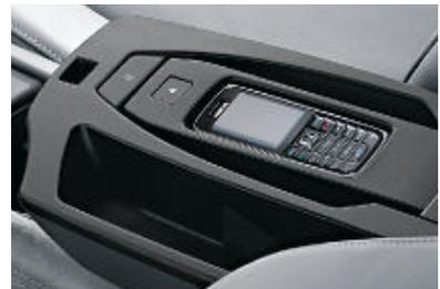
□ **Préparation pour téléphone portable Bluetooth**, dispositif mains libres, connexion pour recharge et antenne extérieure. Un adaptateur disponible séparément permet de brancher un téléphone et de le commander entre autres à partir de l'iDrive (en combinaison avec un système de navigation optionnel). Votre Concessionnaire BMW vous informera sur les téléphones compatibles.
