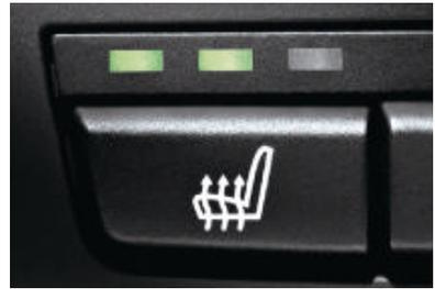
□ **Sièges avant chauffants** (à trois niveaux de réglage) : l'assise, le dossier et les flancs des sièges sont chauffants. Ils diffusent une agréable chaleur en peu de temps.
