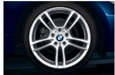
**Jantes en alliage léger 18" style 261 M à rayons doubles** avec monte pneumatique mixte RSC permettant le roulage à plat. Dimensions : 7,5 J x 18 pouces à l'avant, pneumatiques 215/40 R 18 ; 8,5 J x 18 pouces à l'arrière, pneumatiques 245/35 R 18. De série sur BMW 135i Sport Design.
