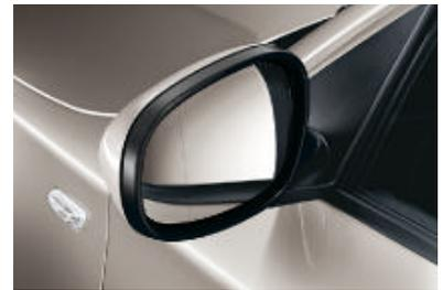
■ **Rétroviseurs extérieurs** dans la teinte de la carrosserie, réglables électriquement et chauffants.
