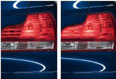
■ **Feux de stop bi-intensité.** Ils permettent aux automobilistes qui vous suivent de mieux évaluer votre intensité de freinage. En cas de freinage d'urgence, la surface éclairée des feux de stop s'agrandit. Il est ainsi plus facile de faire la différence entre un freinage léger et un freinage appuyé – pour encore plus de sécurité.
