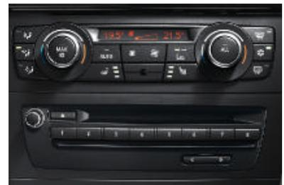
■ **Climatisation automatique bi-zone avec mode cabriolet**, y compris filtre à charbon actif, capteurs de buée et d'ensoleillement. Réglage individuel de la température gauche/droite.
