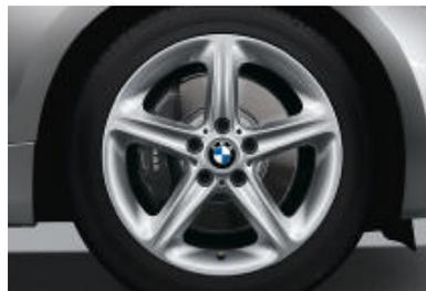
□ **Jantes en alliage léger 18" style 264 à rayons en étoile** avec monte pneumatique mixte RSC permettant le roulage à plat. Dimensions : 7,5 J x 18 pouces à l'avant, pneumatiques 215/40 R 18 ; 8,5 J x 18 pouces à l'arrière, pneumatiques 245/35 R 18. De série sur BMW 135i.
