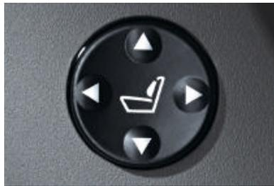
□ **Sièges avant avec soutien lombaire** réglable électriquement en hauteur et en profondeur pour une ergonomie parfaite et un excellent soutien des muscles dorsaux.
