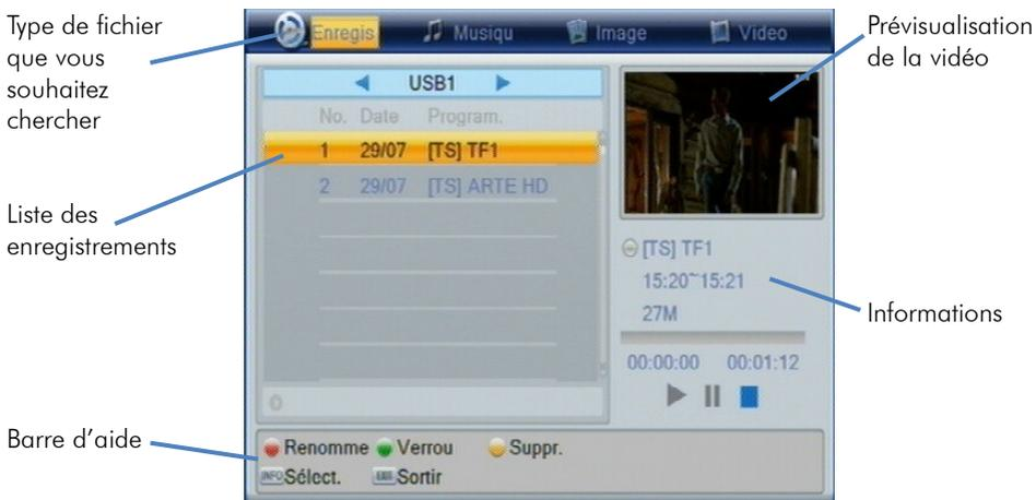
**NOTA** : Le menu Médias USB\Enregis est directement accessible via la touche LIST USB de la télécommande. De plus l'interface s'ouvre directement dans le bon dossier. Les enregistrements sont nommés avec l'extension du format d'enregistrement et le nom de la chaîne. De plus, la date est associée à chaque enregistrement. Utilisez les touches suivantes :
