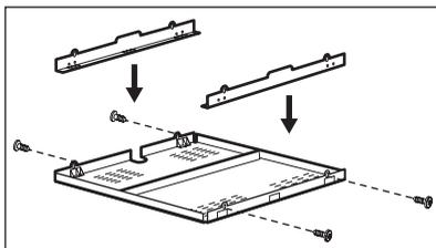
Si vous utilisez une enceinte de protection (accessoire en option<sup>1)</sup>), l'espace de circulation d'air de 2 mm et le fond de protection installé directement sous l'appareil ne sont plus nécessaires.
