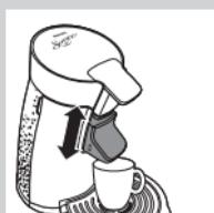
**3 Placez une ou deux tasses sous les orifices d'écoulement. Vous pouvez régler la hauteur de l'unité d'écoulement en la faisant glisser vers le haut ou vers le bas.**
