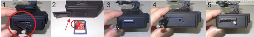
Suivre les étapes, tourner le vis pour ouvrir le couvercle, insérer la carte SD (Vérifier la position de carte SD et que la carte soit déverrouillée), remettre le couvercle et le verrouiller.
