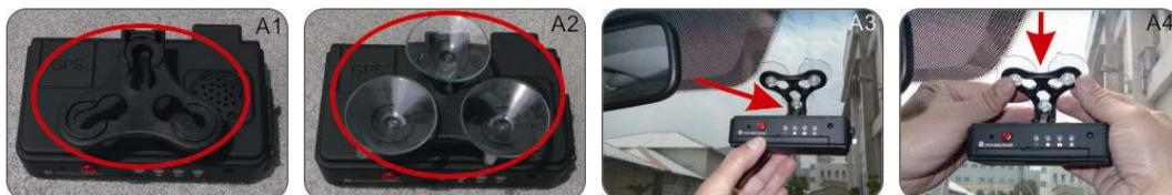
Dresser le support vers le haut, assembler les ventouses, configurer l'appareil à la bonne position, régler l'angle de vision.
