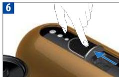
Allumez la machine en ouvrant la fenêtre coulissante en la poussant vers l'arrière de la machine. Voyant clignotant: chauffage pendant approx. 25 sec. Voyant allumé en continu: prêt.
