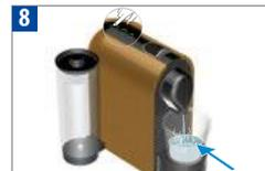
Placez un récipient sous l'orifice de sortie du café. Appuyez sur le bouton Lungo. Fermez la fenêtre coulissante pour rincer la machine. Répétez trois fois cette opération.
