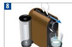
Verrouillez la fermeture coulissante pour lancer le détartrage. La machine s'arrête quand le réservoir d'eau est vide.
