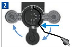
Selon votre souhait d'avoir le réservoir d'eau à gauche ou à droite, passez le câble dans la fente de gauche ou de droite. Installez la machine en position verticale.
