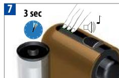
Appuyez sur les 3 boutons en même temps pendant au moins 3 secondes. Un court signal sonore confirmera l'enclenchement. Les boutons de commande se mettront à clignoter rapidement.
