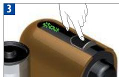
Mettez la machine en marche en poussant la fenêtre coulissante ou en touchant les boutons. Lumière clignotante sur l'une des touches de café: chauffage pendant environ 25 secondes. Voyant allumé en continu: prêt.
