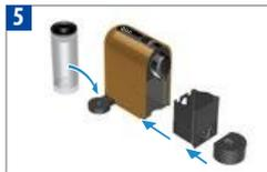
Placez le réservoir d'eau sur son bras, il est fixé avec des aimants. Insérez le bac d'égouttage et le collecteur de capsules usagées. Pour votre sécurité, utilisez la machine uniquement avec le bac d'égouttage et le collecteur de capsules usagées en place.
