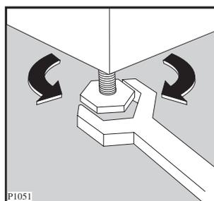
Une mise à niveau correcte évite des vibrations, du bruit ou des déplacements de l'appareil durant son fonctionnement. Assurez-vous, en outre, que pendant son fonctionnement, l'appareil ne touche pas le mur, les meubles, etc.
