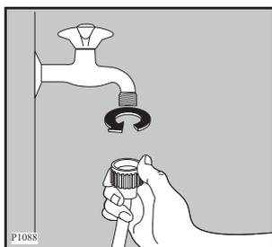
Si nécessaire, rectifiez la position du raccord du tuyau d'alimentation en dévissant la bague de serrage placée à l'arrière de l'appareil. Veillez ensuite à visser correctement la bague de serrage pour éviter toute fuite.
