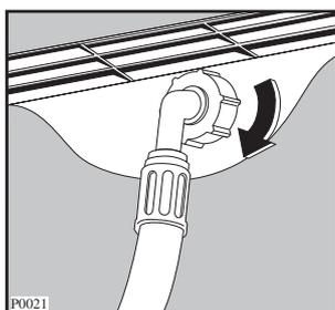
Si le branchement se fait sur des tuyauteries neuves ou qui n'ont pas servi depuis longtemps, il est préférable de faire couler une certaine quantité d'eau avant de mettre en place le tuyau de remplissage. De cette façon, on évitera que du sable ou de la rouille bouche le filtre placé à l'intérieur de l'appareil.
