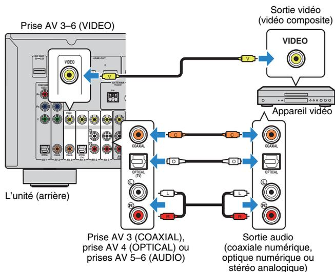
Si vous appuyez sur AV 3-6 pour sélectionner la source d'entrée, les signaux vidéo/audio lus par l'appareil vidéo seront restitués sur l'unité.
