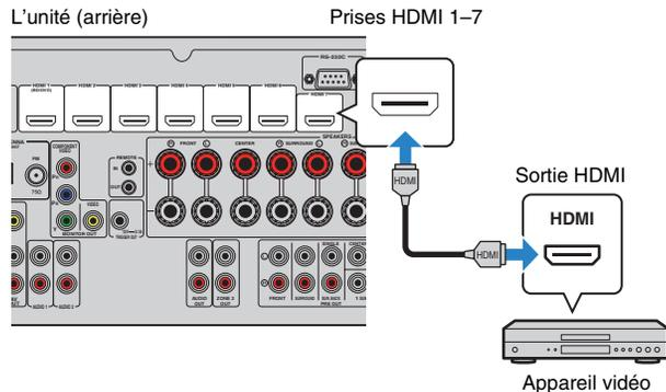
Si vous appuyez sur HDMI 1-7 pour sélectionner la source d'entrée, les signaux vidéo/audio lus par l'appareil vidéo seront restitués sur l'unité.
