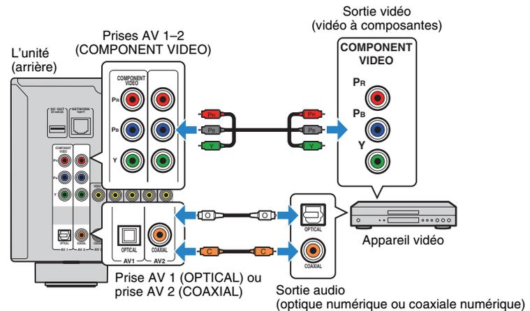
Si vous appuyez sur AV 1-2 pour sélectionner la source d'entrée, les signaux vidéo/audio lus par l'appareil vidéo seront restitués sur l'unité.
