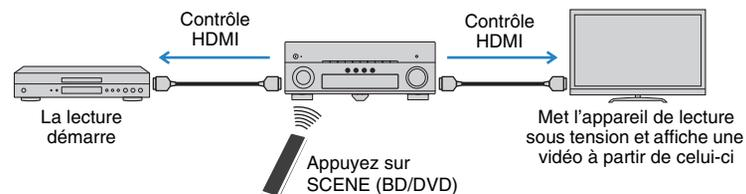
Pour utiliser le contrôle HDMI, vous devez procéder au réglage de la liaison du contrôle HDMI suivant après avoir raccordé le téléviseur et les appareils de lecture.
