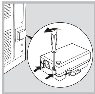
1. Licht de lipjes aan de zijkant van het deksel van het klemmenbord op met een schroevendraaier: trek het deksel van het klemmenbord open (zie afb.).
