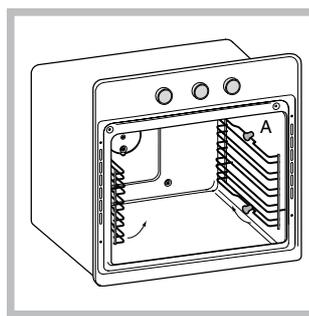
1. Verwijder de twee draagrekken door ze uit de afstanders A te trekken (zie afbeelding).
