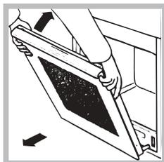
3. fassen Sie die Tür an den beiden äußeren Seiten und schließen Sie sie langsam, jedoch nicht ganz. Ziehen Sie die Tür dann zu sich hin aus ihrer Lagerung heraus (*siehe Abbildung*). In umgekehrter Reihenfolge wird die Backofentür wieder angebracht.
