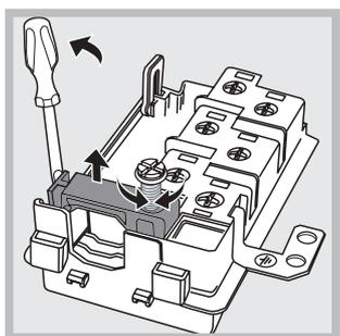
2. DEVISSER LA VIS DU SERRE-CABLE ET LE RETIRER EN FAISANT LEVIER A L'AIDE D'UN TOURNEVIS (*VOIR FIGURE*).
