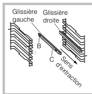
2. Choisissez le gradin sur lequel monter la glissière coulissante. Positionnez sur le cadre d'abord le dispositif de fixation B puis le C en veillant à bien respecter le sens d'extraction de la glissière.
