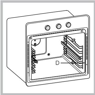
3. Befestigen Sie die mit den Gleitschienen versehenen beiden Rahmen in den entsprechenden Löchern der Backofenrückwand (siehe Abbildung). Die oberen Löcher sind für den linken Rahmen bestimmt, die unteren
