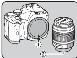
**3** Alignez le repère de la monture de l'objectif (point rouge) sur le boîtier et l'objectif puis tournez l'objectif dans le sens horaire jusqu'à ce qu'il s'enclenche en position.
