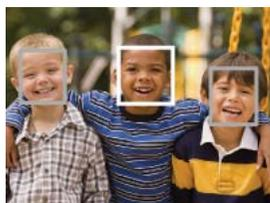
Lorsque l'appareil détecte plus d'un sujet, il juge quel est le sujet principal et règle la mise au point par priorité. Le cadre pour lequel la mise au point est réglée devient vert en enfonçant le déclencheur à mi-course.
