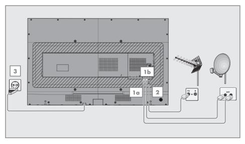
1a Pour recevoir des chaînes numériques satellites (DVB-S), branchez le câble de l'antenne satellite à la prise de l'antenne »SATELLITE MAIN« sur le téléviseur;
