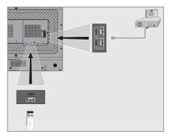
Connectez l'interface USB »USB1« ou »USB2« sur le téléviseur et la sortie des données con-nexes sur le périphérique externe (disque dur externe, caméra numérique, lecteur de carte ou lecteur MP3) à l'aide d'un câble USB;
