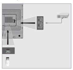
1 Connectez le disque dur externe à l'interface USB »USB1« ou »USB2« du téléviseur ;
