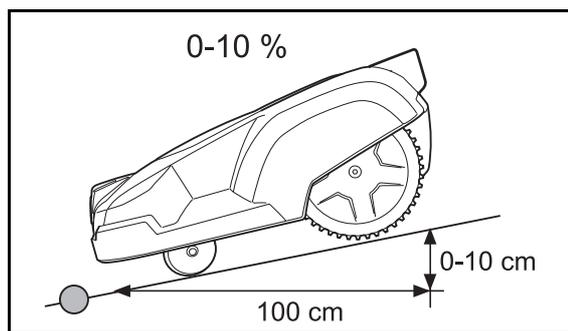
Le câble périphérique ne doit pas être posé en travers d'une pente d'une inclinaison supérieure à 10 %. Automower aurait du mal à tourner. La tondeuse s'arrête et affiche le message d'erreur *En dehors zone de tonte*. Le risque est particulièrement important par temps humide dans la mesure où les roues risquent de dérapier dans l'herbe mouillée.
