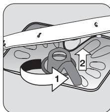
Tournez la poignée d'un 1/4 de tour dans le sens inverse des aiguilles d'une montre et enlevez les filtres B et C.
