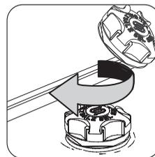
Serrez le bouchon en le tournant dans le sens des aiguilles d'une montre, jusqu'à ce que vous entendiez un clic.
