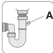
Lorsque vous raccordez le tuyau de vidange à un embout du siphon sous l'évier, n'oubliez pas d'enlever, toute la membrane de plastique(A). Si vous oubliez d'enlever toute la membrane, des particules d'aliments risquent de s'accumuler avec le temps et de boucher l'embout du tuyau de vidange du lave-vaisselle.
