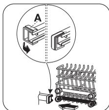
Glissez le panier dans la position la plus haute et remplacez les butées (A) dans leur position d'origine.
