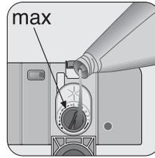
Remplir le distributeur de liquide de rinçage. Le niveau maximum de remplissage est signalé par "max".
