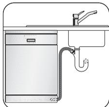
Raccordez le tuyau de vidange au siphon de l'évier. Fixez-le avec le collier de serrage fourni.
