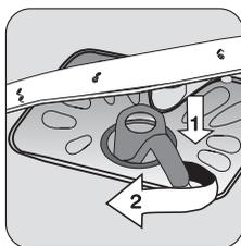
Remplacez les filtres et bloquez-les en tournant la poignée dans le sens des aiguilles d'une montre jusqu'à la butée.
