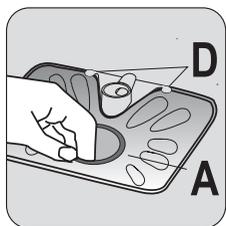
Réinstallez le filtre plat A dans le fond de la cuve en veillant à ce qu'il soit bien installé sous les deux rails D.
