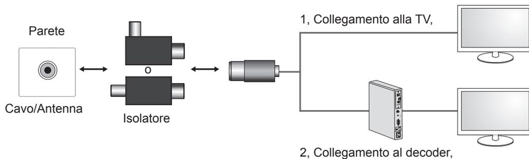
Collegare un'estremità dell'isolatore al jack del cavo/antenna e l'altra al decoder o al set della TV.
