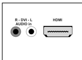
Branchez une extrémité du câble au connecteur HDMI situé à l'arrière du TV LCD et l'autre extrémité du câble à la sortie DVI du PC.
