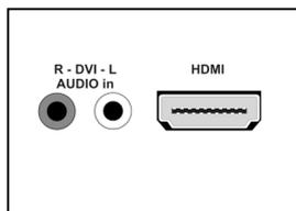
Branchez une extrémité du câble au connecteur HDMI situé à l'arrière du TV LCD et l'autre extrémité du câble à la sortie DVI du PC.
