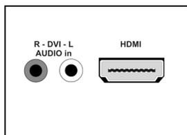
Cette prise permet le raccordement de tout appareil équipé d'une prise HDMI. Le standard HDMI permet une transmission numérique des données vidéo et audio à travers un seul connecteur.
