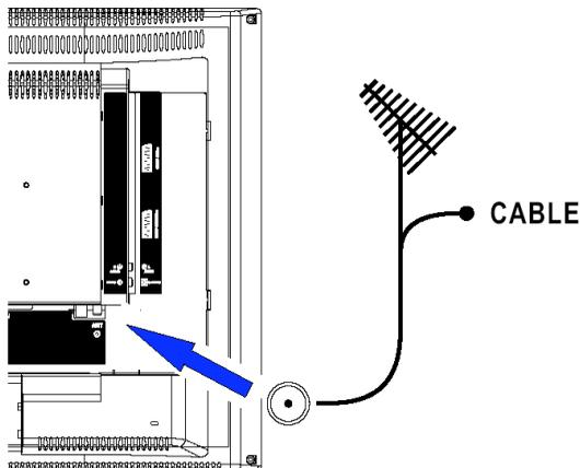
*La prise antenne (75 ohms - VHF / UHF / câble) permet le raccordement de l'antenne extérieure ou d'un autre appareil équipé d'un modulateur (magnétoscope, récepteur satellite, etc.).*
