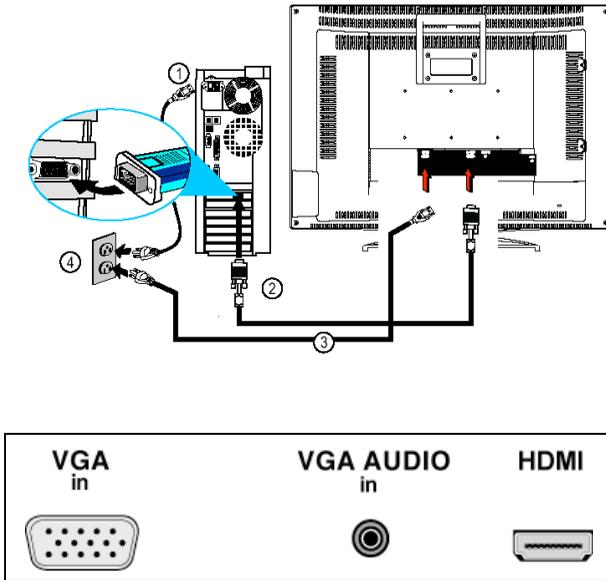
Branchez une extrémité d'un câble mini D-sub 15 broches au connecteur (PC IN D-sub) situé à l'arrière du TV LCD et l'autre extrémité du câble à la sortie du PC (2).
