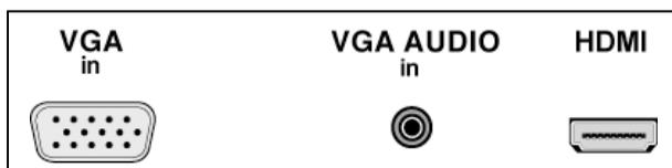
Cette prise permet le raccordement de tout appareil équipé d'une prise HDMI. Le standard HDMI permet une transmission numérique des données vidéo et audio à travers un seul connecteur.
