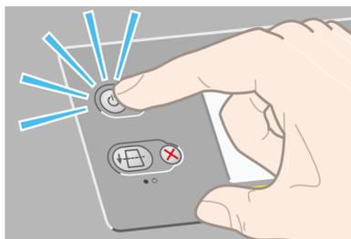
Lorsque vous procédez ainsi pour mettre l'imprimante hors tension, les têtes d'impression sont automatiquement stockées avec leurs dispositifs de nettoyage afin d'éviter qu'elles ne sèchent.
