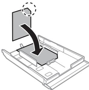
Utilisez le bac 2 lorsque vous chargez des enveloppes. Chargez les enveloppes avec le côté court en premier, le rabat doit être orienté vers le haut et vers la gauche. Vérifiez ensuite que les enveloppes ne dépassent pas du bord du bac.
