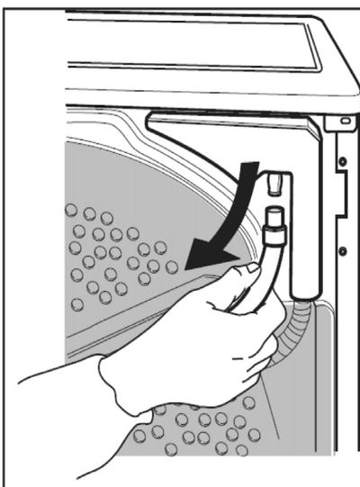
**B.** Retirez le tuyau du couvercle de protection arrière.
