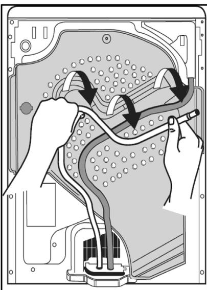
**C.** Raccordez le tuyau au système d'égout. La différence de hauteur entre le sol où est installé le sèche-linge et le raccord au système d'égout ne doit pas dépasser 1 m.
