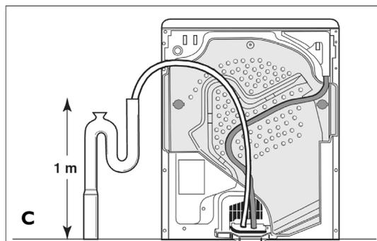
**Remarque :** pour éviter le refoulement, l'extrémité du tuyau ne doit pas être plongée dans l'eau de vidange. Évitez de plier et de tordre le tuyau flexible.
