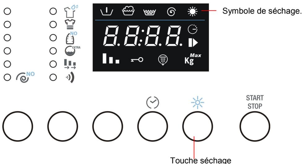
Le programme de lavage précédemment sélectionné détermine si le séchage est normal (90°C) ou délicat (60°C).
