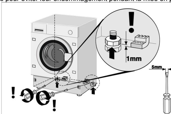
Après avoir encastré l'appareil dans la cuisine, lever les pieds arrière pour éviter que l'appareil pose sur les patins. Après avoir levé les pieds arrière, mettre l'appareil de niveau et fixer les pieds avant.
