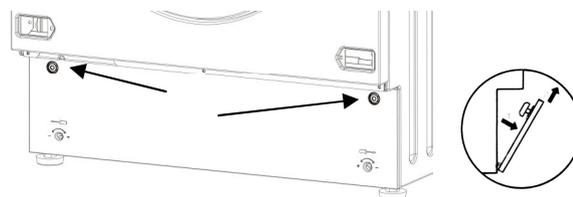
Modèle pose libre – Introduire un petit tournevis dans les fentes se trouvant sur la partie avant du socle puis exercer une légère pression vers le haut afin de libérer la partie supérieure du socle de l'appareil. Incliner le socle légèrement vers l'avant et tirer vers le haut pour l'enlever complètement.
