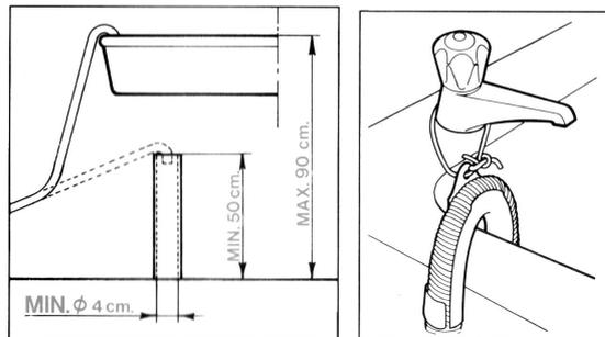
2. Contrôler que l'extrémité du tuyau de vidange soit bien fixée pour empêcher que la force répulsive de l'eau puisse le déplacer de sa position.
