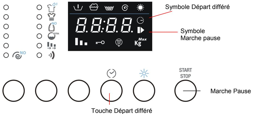
1. En pressant plusieurs fois la touche Départ différé, il est possible de sélectionner après combien de temps le programme de lavage pourra terminer. Le temps à la fin du cycle tient compte de la durée initiale du cycle de lavage/séchage, des sélections faites (température, vitesse d'essorage et options), qui peuvent réduire ou prolonger la durée initiale du cycle et du temps d'attente que l'utilisateur veut ajouter avant le départ.
