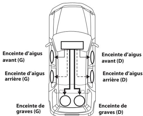
X-OVER pour un système 3WAY dont la plage de fréquences est divisée entre les aigus (avant), les médiums (avant) et les graves (caisson de graves).
