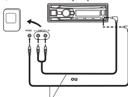
Câble adaptateur en option (connecteur à broche RCA [rouge, blanc] miniprises 3,5ø) ou (miniprises 3,5ø).
