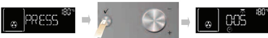
Une fois la durée de cuisson écoulée, l'affichage montre : « PRESS ✓ TO BROWN » (appuyer sur ✓ pour dorer). En appuyant sur la touche ✓, le four lance la phase de dorage pendant 5 minutes. Cette fonction ne peut être exécutée que deux fois.
