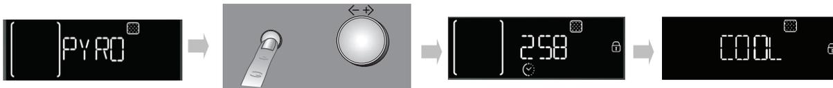
Pour lancer le cycle de nettoyage automatique du four (pyrolyse), procédez de la façon suivante :
