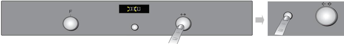
Cette fonction ne peut être utilisée qu'à four éteint et elle est utile, par exemple, pour contrôler le temps de cuisson des pâtes. La durée maximum pouvant être introduite est de 23 heures et 59 minutes.
