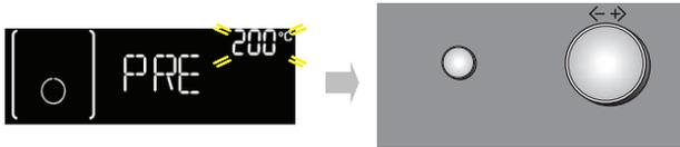
1. Sélectionnez la fonction Préchauffage rapide en tournant le bouton « Fonctions » en face du symbole
