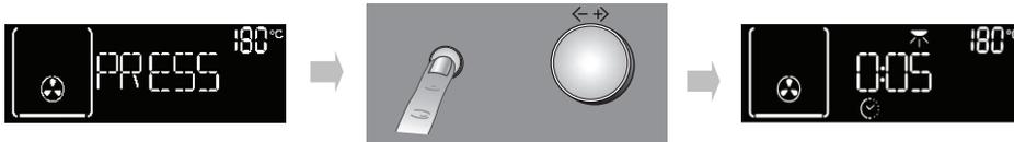
Une fois la durée de cuisson écoulée, l'afficheur montre : « PRESS ✓ TO BROWN » (appuyez ✓ pour dorer). En appuyant sur la touche (3), le four lance la phase de « Dorage » pendant 5 minutes. Cette fonction ne peut être effectuée que deux fois.
