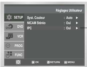
La fonction de contrôle intelligent de l'image (IPC) vous permet de régler automatiquement la netteté de l'image.
