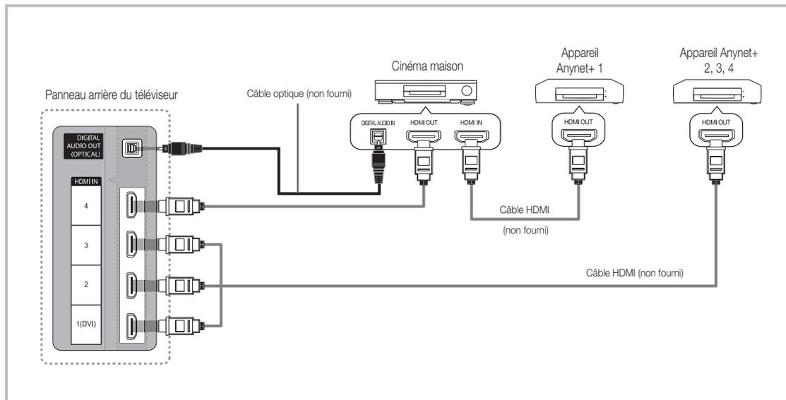
1. Raccordez la prise HDMI IN (1(DVI), 2, 3 ou 4) du téléviseur à la prise de sortie HDMI OUT de l'appareil Anynet+ correspondant à l'aide du câble HDMI.
