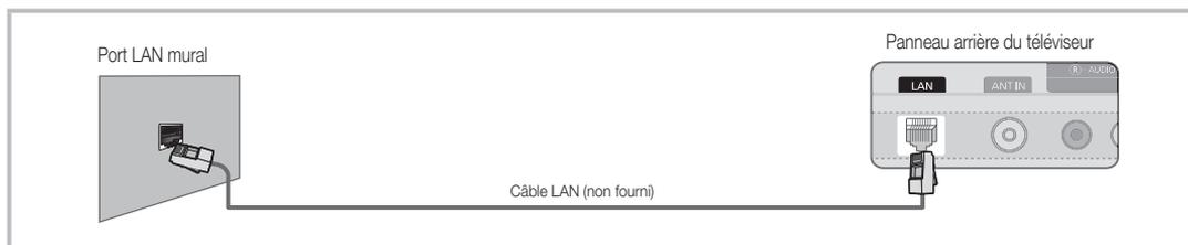
Si vous possédez un réseau dynamique, vous devez utiliser un modem ou routeur LNPA prenant en charge le protocole DHCP (Dynamic Host Configuration Protocol). Les modems et routeurs qui prennent en charge le protocole DHCP fournissent l'adresse IP, le masque de sous-réseau, la passerelle et les valeurs DNS dont votre téléviseur a besoin pour accéder à Internet, de sorte que vous n'avez pas à les entrer manuellement. La plupart des réseaux domestiques sont des réseaux dynamiques.
