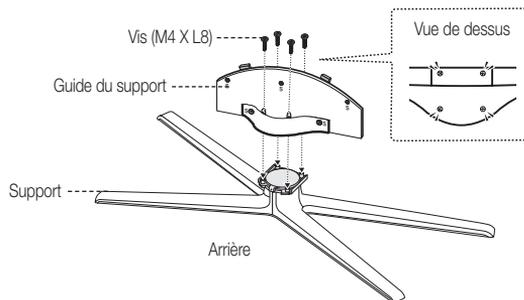
1. Fixez le guide de la base sur la base à l'aide des quatre vis (M4 X L8), tel qu'illustré.
