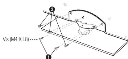
3. Resserrez les deux vis (M4 X L8) à la position ①, puis resserrez les deux vis (M4 X L8) à la position ②.
