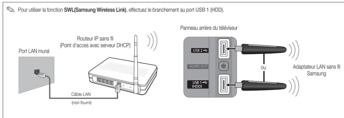
L'adaptateur LAN sans fil Samsung est vendu séparément chez un de nos détaillants sélectionnés, dans les boutiques en ligne ou sur le site Samsungparts.com. L'adaptateur LAN sans fil Samsung prend en charge les protocoles de communication IEEE 802.11A/B/G et N. Samsung recommande l'utilisation du protocole IEEE 802.11N. Lorsque vous faites jouer une vidéo à partir de la connexion IEEE 802.11B/G, il pourrait y avoir de l'interférence pendant la lecture.
