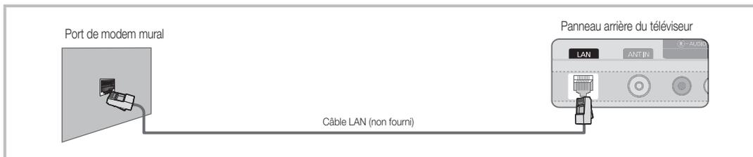
Si vous possédez un réseau dynamique, vous devez utiliser un modem ou routeur LNPA prenant en charge le protocole DHCP (Dynamic Host Configuration Protocol). Les modems et routeurs qui prennent en charge le protocole DHCP fournissent l'adresse IP, le masque de sous-réseau, la passerelle et les valeurs DNS dont votre téléviseur a besoin pour accéder à Internet, de sorte que vous n'avez pas à les entrer manuellement. La plupart des réseaux domestiques sont des réseaux dynamiques.
