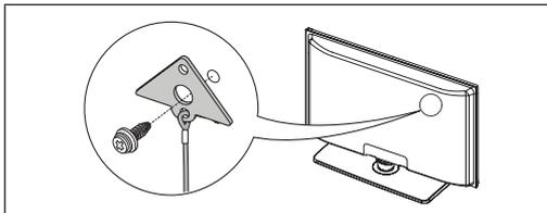
2. Vissez à fond les vis sur le mur ou l'armoire où le téléviseur doit être installé. Pour immobiliser le téléviseur, fixez le cordon relié au téléviseur aux vis vissées dans le mur ou sur l'armoire.
