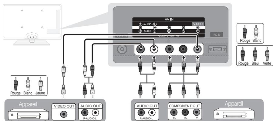
**COMPONENT IN / AV IN:** Lorsque le branchement est effectué à la prise AV IN, la couleur de la prise d'entrée AV IN [Y/VIDEO] (vert) ne correspond pas à la couleur du câble vidéo (jaune).
