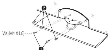
3. Resserrez les deux vis (M4 X L8) à la position ①, puis resserrez les deux vis (M4 X L8) à la position ②.
