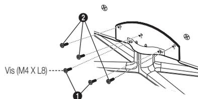
3. Resserrez les deux vis (M4 X L8) à la position ①, puis resserrez les deux vis (M4 X L8) à la position ②.
