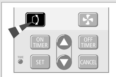
*Selon la hauteur de l'unité intérieure sur le mur de la pièce, vous pouvez régler l'orientation des lames de sortie d'air au bas de l'unité, pour augmenter l'efficacité du climatiseur.*
