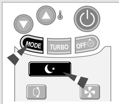
1 Si ☼ n'est pas affiché en haut de la télécommande, appuyez sur le bouton **MODE** (sous le volet de la télécommande) autant de fois que nécessaire pour l'afficher.
