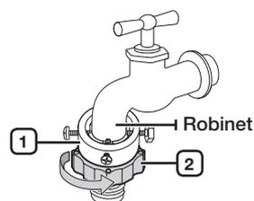
4. Raccordez le tuyau d'arrivée d'eau à l'adaptateur. Lorsque vous lâchez la partie (3), le tuyau se raccorde automatiquement à l'adaptateur en émettant un petit clic d'enclenchement.
