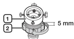
3. Raccordez l'adaptateur au robinet en serrant fermement les vis et en levant l'adaptateur vers le haut. Tournez la partie (2) dans le sens de la flèche, puis raccordez (1) et (2).
