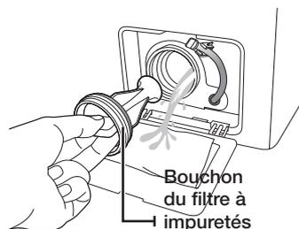
6. Retirez toute impureté et autre corps étranger pris dans le filtre et nettoyez ce dernier. Assurez-vous que l'hélice de la pompe de vidange située derrière le filtre n'est pas bloquée.
