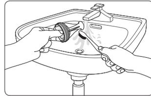
5. Remettez en place le bouchon du filtre à impuretés.
