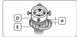
4. Raccordez l'adaptateur au robinet en serrant fermement toutes les vis et en levant l'adaptateur vers le haut. Puis serrez l'adaptateur en tournant la **partie (E)** en suivant la flèche.
