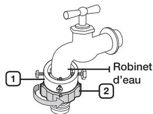
4. Raccordez le tuyau d'arrivée d'eau à l'adaptateur. Lorsque vous relâchez la partie (3), le tuyau se connecte automatiquement à l'adaptateur, en faisant le bruit d'un "clic".
