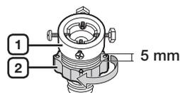
3. Raccordez l'adaptateur au robinet d'eau en resserrant fermement les vis tout en faisant glisser l'adaptateur vers le haut. Tournez la partie (2) dans le sens de la flèche et raccordez (1) et (2)
