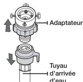
2. Tout d'abord, desserrez les quatre vis de l'adaptateur à l'aide d'un cruciforme. Ensuite, tenez l'adaptateur et tournez la partie (2) dans le sens de la flèche jusqu'à ce qu'il y ait un espace de 5 mm.
