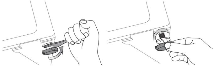
3. Lorsque le lave-linge est de niveau, serrez les écrous à l'aide de la clé fournie.
