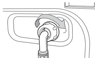
6. Ouvrez l'arrivée d'eau et assurez-vous qu'il n'y ait aucune fuite d'eau au niveau de la valve, du robinet ou de l'adaptateur. S'il y a une fuite d'eau, répétez l'étape précédente.
