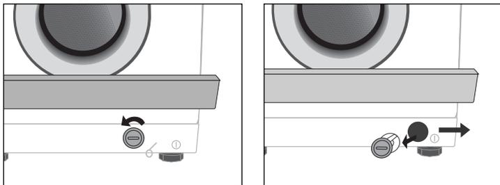
4. Lavez toutes les saletés ou autres matériels du filtre. Faites attention que le propulseur de la pompe de drainage derrière le filtre ne soit pas bloqué. Remplace le bouchon du filtre.
