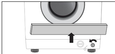
3. Dévissez le bouchon de drainage en le tournant vers la gauche. Tenez fermement le bouchon à l'extrémité du tuyau de drainage et sortez-le lentement d'environ 20 cm.
