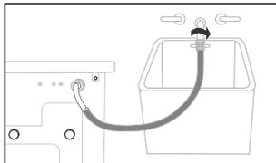
2. Raccordez l'autre extrémité du flexible au robinet d'arrivée d'eau froide et serrez-le à la main. Si nécessaire, vous pouvez raccorder directement le flexible d'arrivée d'eau sur le lave-linge : desserrez le raccord et retirez le flexible, puis installez le tuyau d'arrivée d'eau sur la machine en le verrouillant après vissage.
