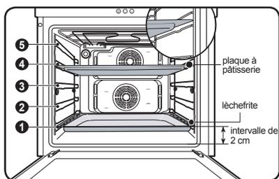
La plaque à pâtisserie, le lèche-frite et la grille métallique doivent être correctement insérés dans les rainures latérales.
