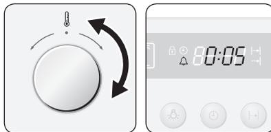
**2** Tournez le **bouton de commande de l'horloge / de la température** pour régler le temps souhaité.
