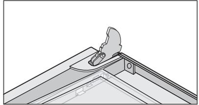
2. Fixez les deux supports à ressort sur la partie supérieure de la vitre n°2 et remettez la vitre n°2 en place.
