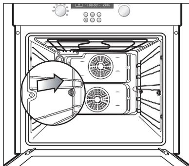
3. Insérez la vis à l'avant et serrez les deux vis.
