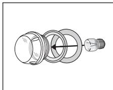
4. Fixez la bague métallique et le joint sur la protection en verre.
