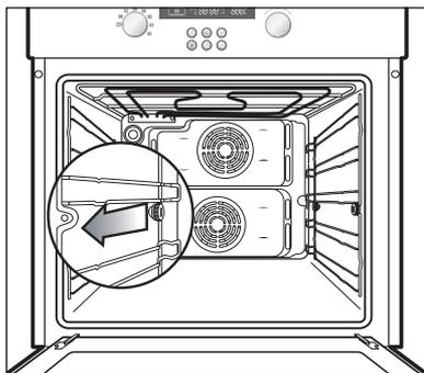
4. Retirez la vis située à l'arrière en la tournant dans le sens inverse des aiguilles d'une montre.
