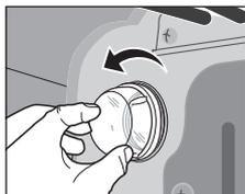
1. Retirez la protection en tournant dans le sens inverse des aiguilles d'une montre.
