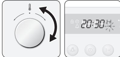
**2** Tournez le **bouton de commande de l'horloge / de la température** pour régler l'heure de fin de cuisson.
