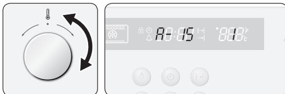
**3** Sélectionnez le poids souhaité en tournant le **bouton de réglage de l'horloge / de la température** vers la droite ou vers la gauche. Le temps de préchauffage (min:sec) s'affiche et le décompte démarre 5 secondes après la sélection du poids. Pour les recettes ne nécessitant pas de préchauffage, le temps de cuisson restant (hr:min) s'affiche.
