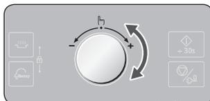
4. Appuyez à nouveau sur le bouton de **Sélecteur**. L'horloge se règle automatiquement dans les 5 secondes.
