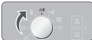
2. Réglez le temps de cuisson en tournant le **Sélecteur multifonction**. (Le temps de cuisson maximal est de 90 minutes.)
