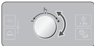
6. Appuyez à nouveau sur le bouton de **Sélecteur**. L'horloge se règle automatiquement dans les 5 secondes.
