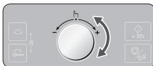
3. Appuyez sur le bouton de **Sélecteur** pour régler la température désirée. (40 à 230 °C)
