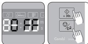
2. Pour réactiver le signal sonore, appuyez à nouveau simultanément sur les boutons **Arrêt/Annulation** et **Départ**.
