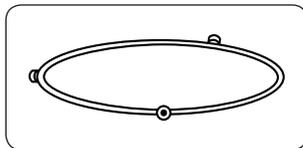
**3. Plateau tournant** : à placer sur l'anneau de guidage en emboîtant la partie centrale sur le coupleur.
