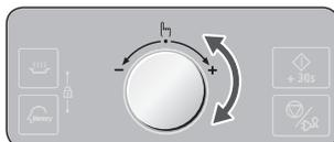
3. Si vous souhaitez changer le niveau de puissance, appuyez sur le bouton de **Sélecteur** puis sélectionnez le niveau de puissance approprié en tournant le **Sélecteur multifonction**.
