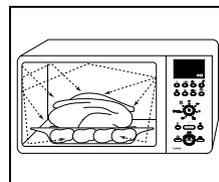
1. Les micro-ondes générées par le magnétron sont réfléchies sur les parois du four et réparties uniformément lorsque les aliments tournent sur le plateau. Les aliments sont donc cuits uniformément.
