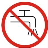
Neem de voorschriften van de plaatselijke drinkwatervoorzieningsbedrijven in acht. Overeenkomstig EN 61 770 mag het toestel niet direct worden aangesloten op het openbare drinkwaternet. Volgens de Duitse instantie DVGW mag het toestel echter voor korte duur worden aangesloten indien de toevoerleiding is voorzien van een terugslagklep met beluchter (Kränzle best. no. 41.016 4). Water achter de terugslagklep geldt niet meer als
