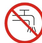
Il est interdit de brancher le nettoyeur HP directement au réseau public de distribution d'eau potable.
