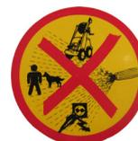
L'utilisation inadéquate du jet haute pression peut être dangereuse. Ne jamais diriger le jet sur une personne, un animal, un équipement électrique actif ou sur l'appareil lui-même.
