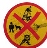
De hogedrukstraal kan bij onveilig gebruik gevaarlijk zijn. De straal mag niet op personen, dieren, actieve elektrische installaties of op het toestel zelf gericht worden.
