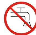
Het toestel mag niet direct aan het openbare drinkwater-net aangesloten worden.
