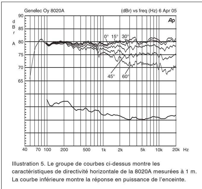
Illustration 5. Le groupe de courbes ci-dessus montre les caractéristiques de directivité horizontale de la 8020A mesurées à 1 m. La courbe inférieure montre la réponse en puissance de l'enceinte.
