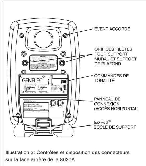
**Illustration 3:** Contrôles et disposition des connecteurs sur la face arrière de la 8020A
