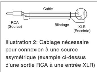
**Illustration 2:** Cablage nécessaire pour connexion à une source asymétrique (exemple ci-dessus d'une sortie RCA à une entrée XLR)
