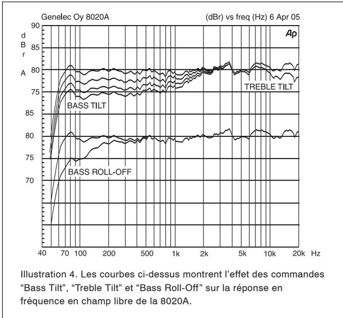
Illustration 4. Les courbes ci-dessus montrent l'effet des commandes "Bass Tilt", "Treble Tilt" et "Bass Roll-Off" sur la réponse en fréquence en champ libre de la 8020A.
